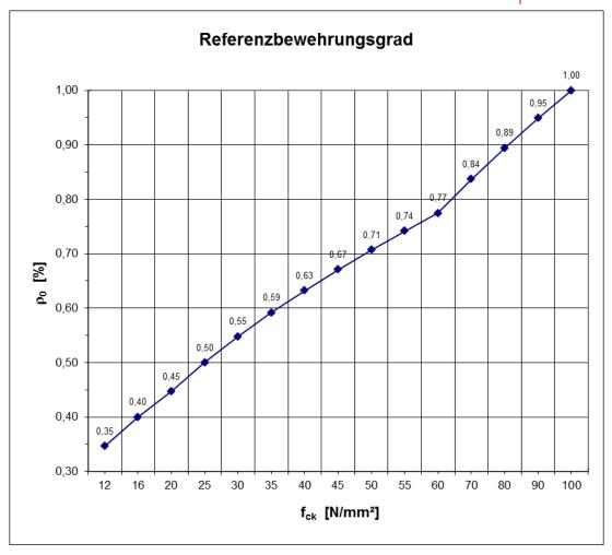
Die durch [2] eingeführte Begrenzung der Biegeschlankheit auf die Maximalwerte für  $\frac{l}{d}$  gibt den oberen Grenzwert der Biegeschlankheit vor. Für den Beiwert K sind entsprechend [1], Tabelle 7.4N in Verbindung mit [2] die folgenden Werte anzunehmen.
