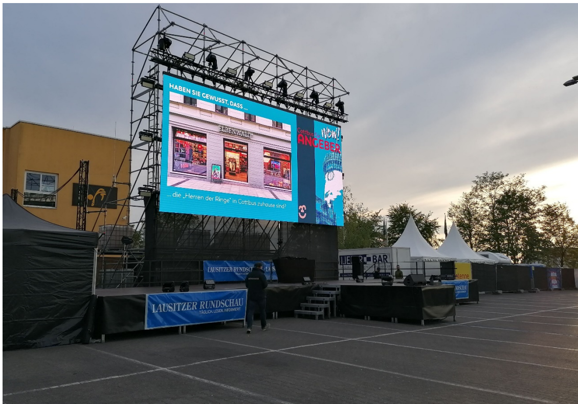
Abbildung 19 LED-Wand, aufgehängt an einem Gerüst
